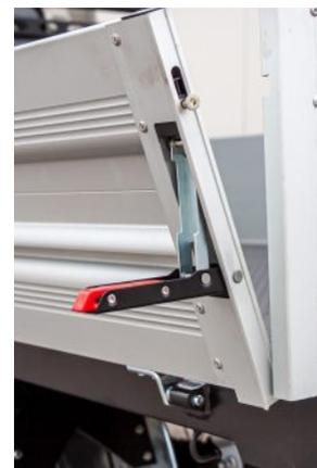
I minimatic che scegliamo hanno un meccanismo al loro interno che permette di eliminare i rumori dovute dalle vibrazioni
