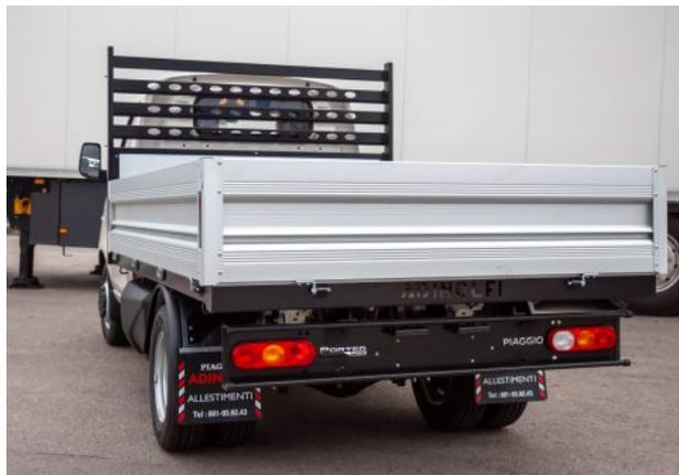
L'altezza del piano di carico vantaggiosa di soli 80 cm per la versione PIANALE FISSO e di soli 90 cm per la versione PIANALE RIBALTABILE
